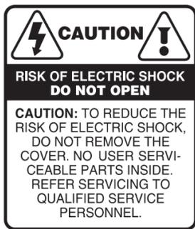
**PRECAUCION:** para disminuir el riesgo de choque eléctrico, no quite la cubierta, no hay piezas adentro que el usuario pueda reparar, deje todo el mantenimiento a los técnicos calificados.
