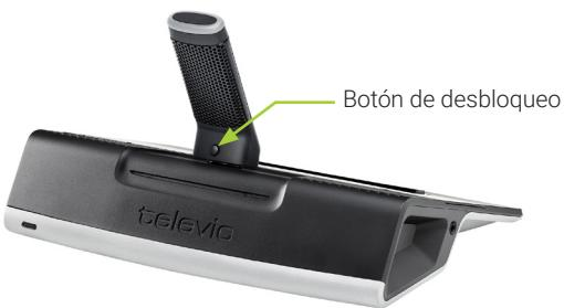
En cuanto se inserta el micrófono, la unidad Confidea FLEX G4 lo detecta y ajusta automáticamente los parámetros de audio.
